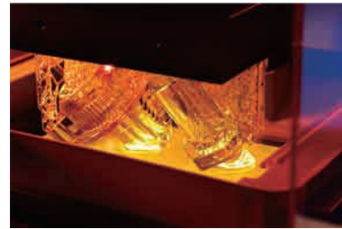
レーザーユニット 4 (LPU4) がバックライトユニットから放射される光線をレイヤーの形状に正確に変形。
